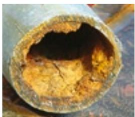
Derart verrostete Rohre sind keine Seltenheit. Die Rostschicht bewirkt Rohrverengungen, Druckabfall, Rostwasser, Durchrostungen und in der Folge teure Wasserschäden.
